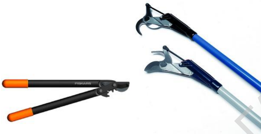
Рис. 14. Сучкорезы (воздушные секаторы)
